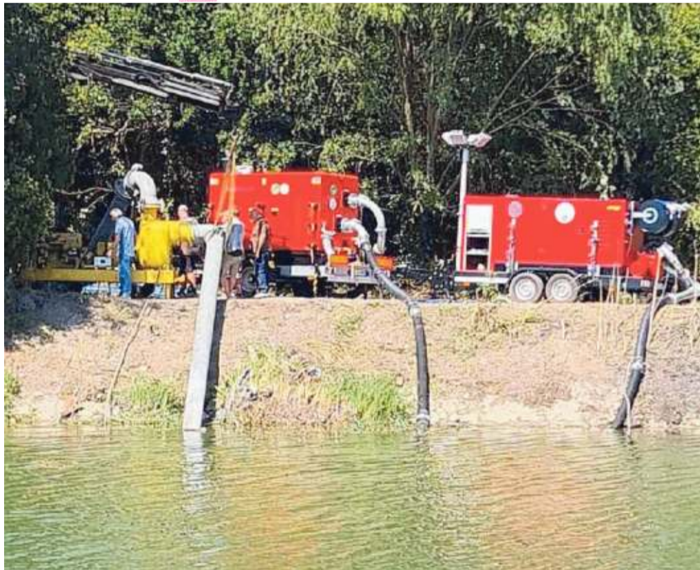
L'acqua viene pompata dal canale Brian dalla Protezione civile, per rifornire Caorle
