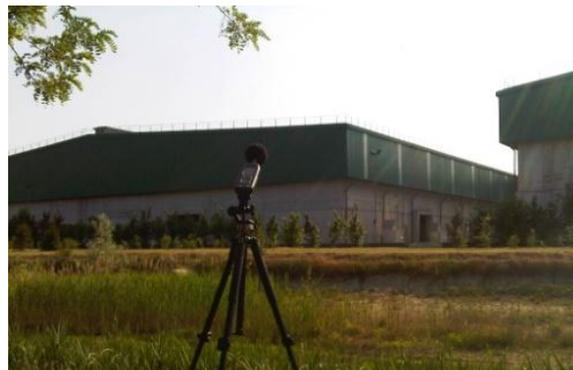
**Figura 15: Monitoraggio del rumore con fonometro in loc. Summaga (Fonte dati: Sinpro Ambiente S.r.l.)**
