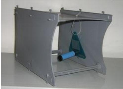
Figura 5: Campionatore passivo tipo "Radiello"
