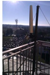
La strumentazione impiegata è costituita da una sonda ricettiva al cui interno è alloggiato un modem per il collegamento da remoto che consente lo scarico dei dati acquisiti. Il monitoraggio è attivo 24 ore su 24 salvo i periodi di manutenzione e calibrazione della strumentazione.
