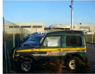
**Figura 3: Mezzo mobile comunale per il monitoraggio dell'aria**
